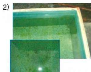
半年後に水槽をチェックしてもユニ・ガーディアンの剥離は無く、表面に苔が付着しているだけ。
