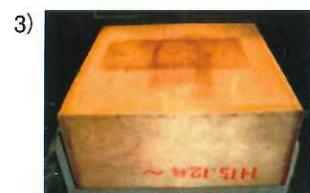
水槽内の水を捨てユニ・ガーディアンとコンパネの接着状態を点検し、剥離の兆候が無いことを確認する。さらにコンパネの箱を逆さまに水漏れをチャックし全く漏水が無いことを確認する。
