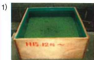
水槽に見立てたコンパネにユニ・ガーディアンをブラシで2度塗りし乾燥後高さ150mmまで水道水を注入し屋外に放置する。
